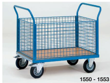
Construction en tubes/profilés d'acier soudés, revêtement par poudre, surface protégée longue durée et résistante aux chocs. Plateforme: en bois, surface décor hêtre, 2 roulettes pivotantes, 2 fixes, bandage caoutchouc 160 x 40 bzw. 200 x 50 mm respectivement.
