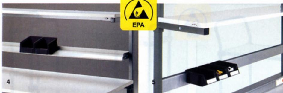
**4. Étagère pour bacs:** Pour bacs à bec et de rangement. Hauteur et inclinaison réglables. En acier revêtu par poudre conductrice. Charge maxi 30 kg.
